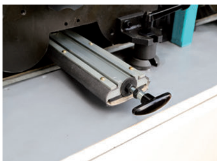
3 Алюминиевая шлифовальная накладка, большая площадь контакта, хороший полировальный эффект. Специальный дизайн с раздвоенным концом увеличивает устойчивость.
