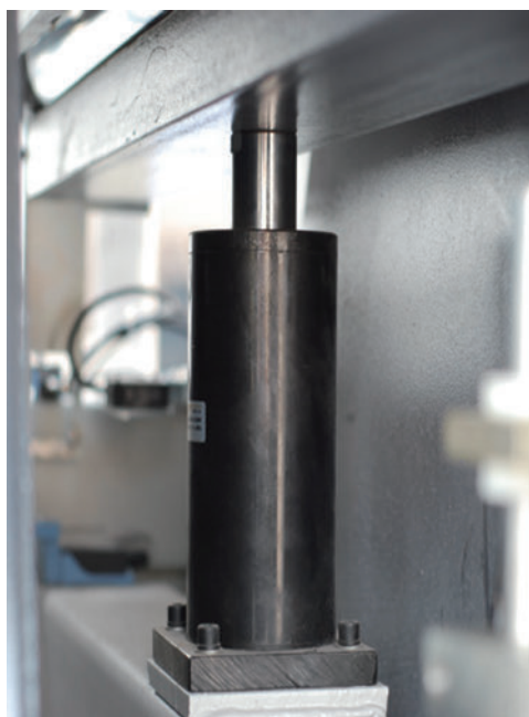
1 Цилиндр высокого давления, прочный шток поршня с улучшенной устойчивостью
