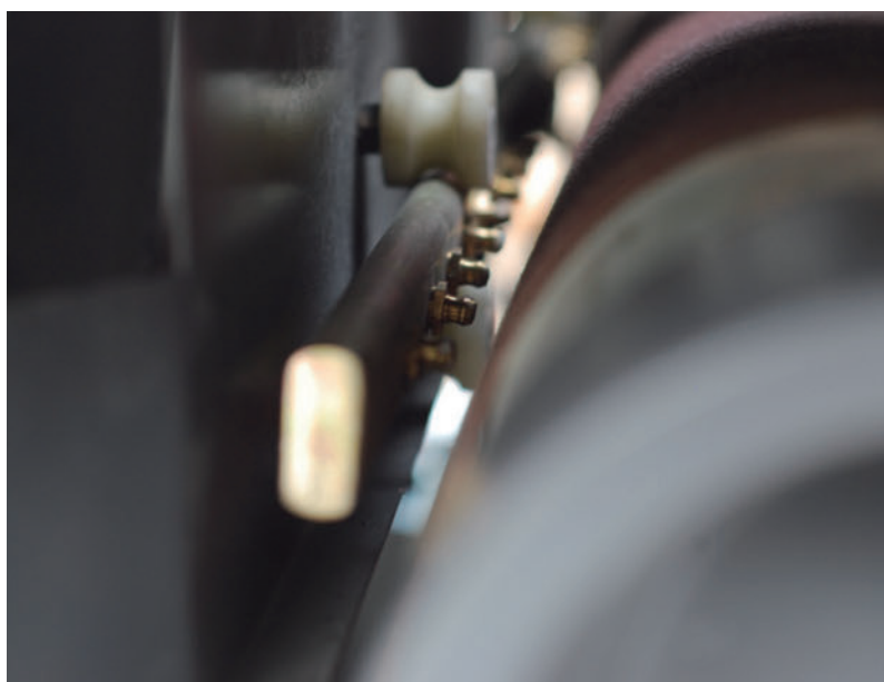
10 Устройство обдува шлифовальной ленты автоматически очищает поверхность от пыли во время работы шлифовальной ленты.
